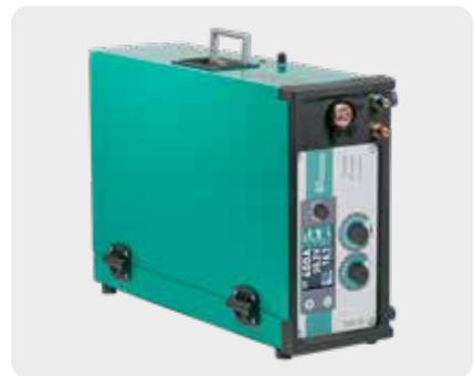
Ausklappbarer Tragegriff, 2 x 4 GummifüÙe an Unter- und Längsseite zum Abstellen.
