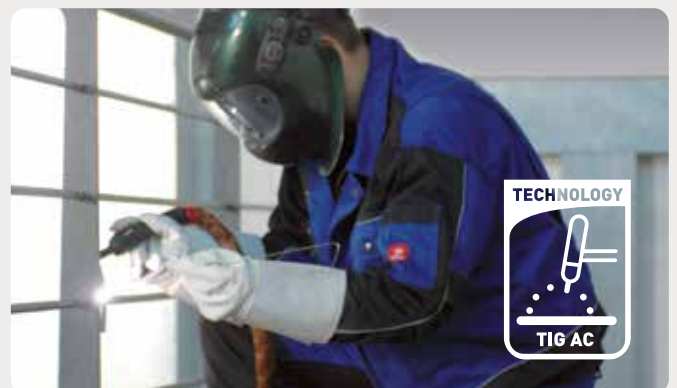
TIG (WIG)-Schweißen AC für Aluminium (LiteTIG 190 und 210 AC/DC)
