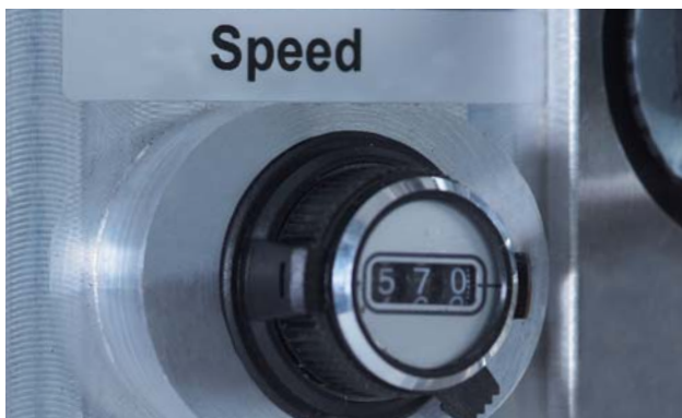
Exakte Geschwindigkeits-Einstellung über Mehrgang-Potentiometer.
