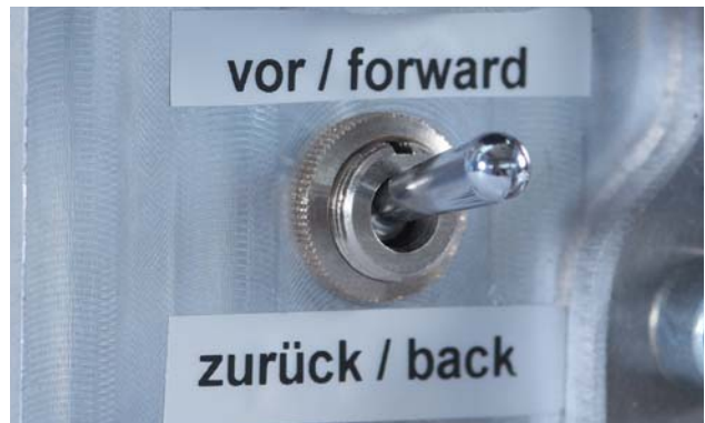
Schweißen in Vorwärts- und Rückwärts-Richtung möglich.
