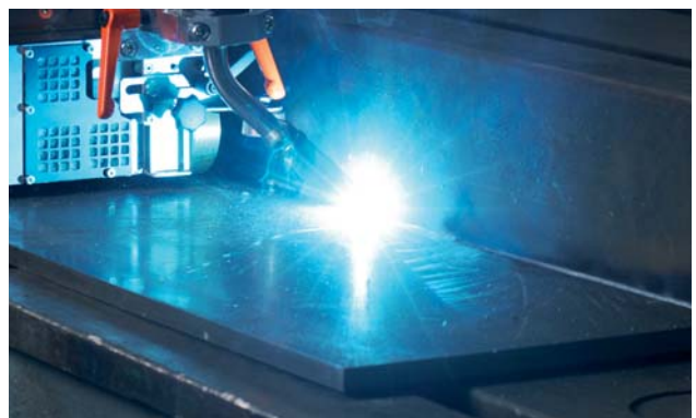
Konstante Fahrgenauigkeit durch tachogeregelten Antrieb.
