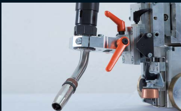
Aufnahme für unterschiedliche Brennerköpfe.
