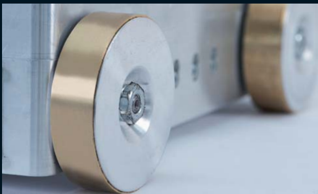
Fahrwerk mit 4 magnetischen Rädern für perfekten Geradeauslauf.
